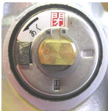
写真4 安全弁元弁「閉」の状態
