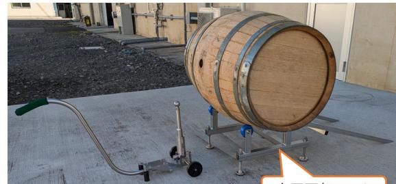
専用回転ラックにより、樽の積み下ろし、ノズル差し込みが容易におこなえます。
