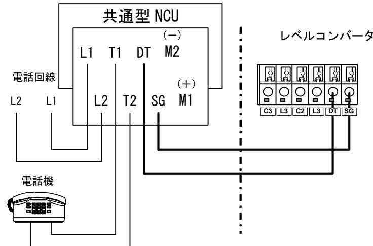
(接点信号 L 2 出力を使用する場合の結線の例)
