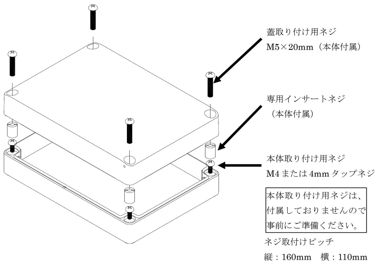
**注意** レベルコンバータの蓋を外した際、内部に異物が混入しないように十分注意してください。異物が混入すると故障の原因になることがあります。
